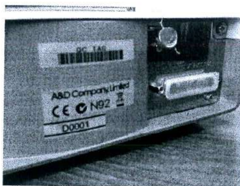
Рисунок 2 – Схема пломбировки весов от несанкционированного доступа
