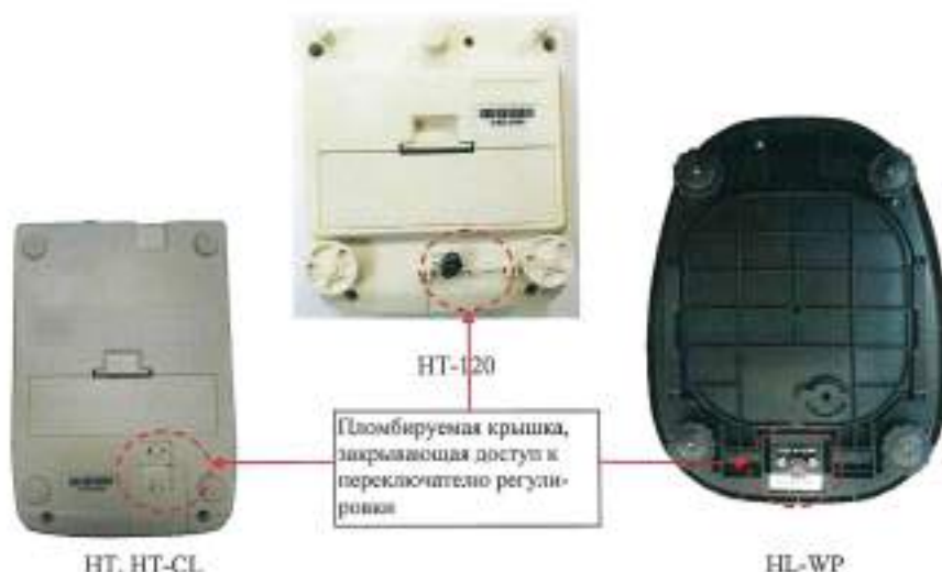
Рисунок 2 - Схема пломбировки весов от несанкционированного доступа
