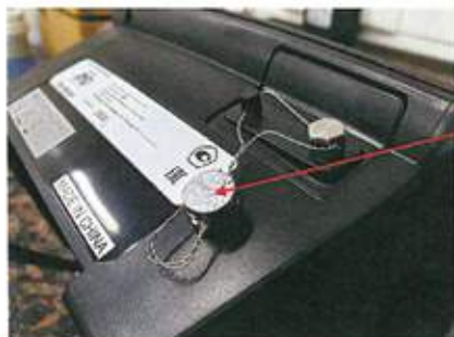
Рисунок 3 – Схема пломбировки от несанкционированного доступа, место нанесения знака поверки
